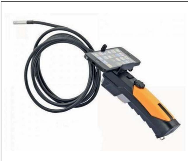
**Foto 1** - Nella foto 1 è riportato il modello del boroscopio flessibile che è stato usato durante lo studio. Da notare che questo modello di boroscopio è formato da una base solida, in cui sono contenute delle batterie e in cui è possibile inserire uno smartphone per la visualizzazione delle immagini, e da un cavo flessibile alla cui estremità è presente una videocamera e una sorgente di luce LED (foto tratta da [www.amazon.ca](http://www.amazon.ca)).
